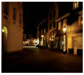
Hohe Leuchtdichten auf den Fassaden stehen im Widerspruch zu den teils mäßig ausgeleuchteten Verkehrsflächen.
