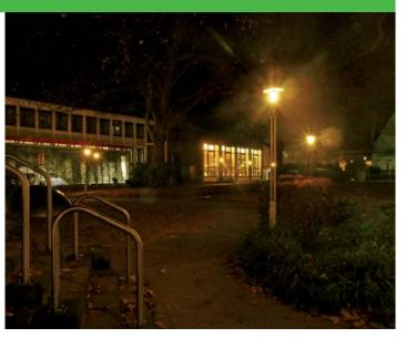
Die veralteten Pilzkopfleuchten mit freistrahlender Lichttechnik beleuchten die Fußwege nur unzureichend, sodass die Wegeverbindung nachts ein Gefühl der Unsicherheit vermittelt. Die Leuchten sind zum Teil defekt und in baulich schlechtem Zustand.
