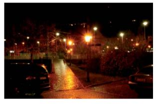
Sonderleuchte, einfach Lichtpunkthöhe 4,50m
