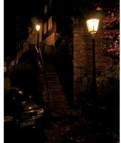
Die Gassen und Treppen werden durch das Streulicht der freistrahlenden Leuchten schwach erhellt. Dabei werden vor allem die vertikalen Flächen beleuchtet, was der Gesichtserkennung zugute kommt. Gleichzeitig erreicht kaum Licht die horizontale Nutzfläche, sodass die Treppen zu Stolperfallen werden.
