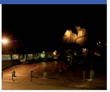
Die mastbefestigten Pendelleuchten auf der Mauer entlang der Löher Straße sind nicht in Betrieb. Der vordere Bereich des Domvorplatzes wird durch einen Strahler geflutet, dessen Ausrichtung ein hohes Maß an Blendung verursacht. Die Präsenz vieler dunkler, uneinsehbarer Ecken mindert das subjektive Sicherheitsgefühl auf dem Platz.
