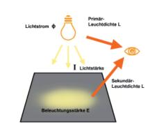
Abbildung Lichttechnische Grundgrößen
